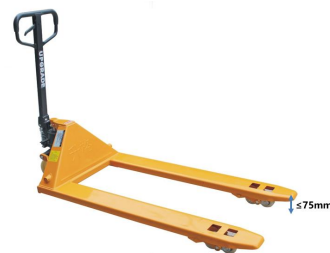
液压叉车周转叉齿高度要求示意图
