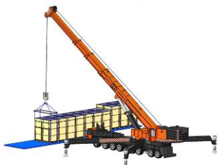
Descarga de paquetes verticales lado largo con grúa
