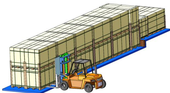
Descarga de paquetes verticales lado corto y paquetes en forma de U con montacargas
