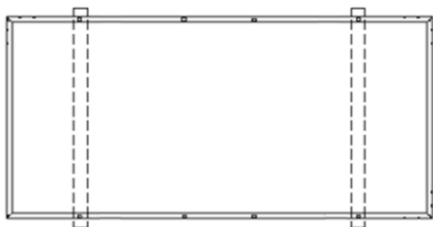
图 4 66cell 光伏组件外四孔螺栓安装
