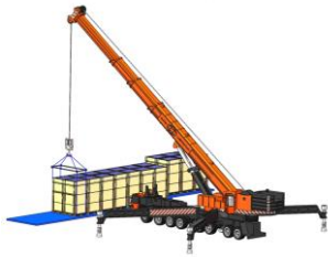
长边立式吊车卸货示意图
