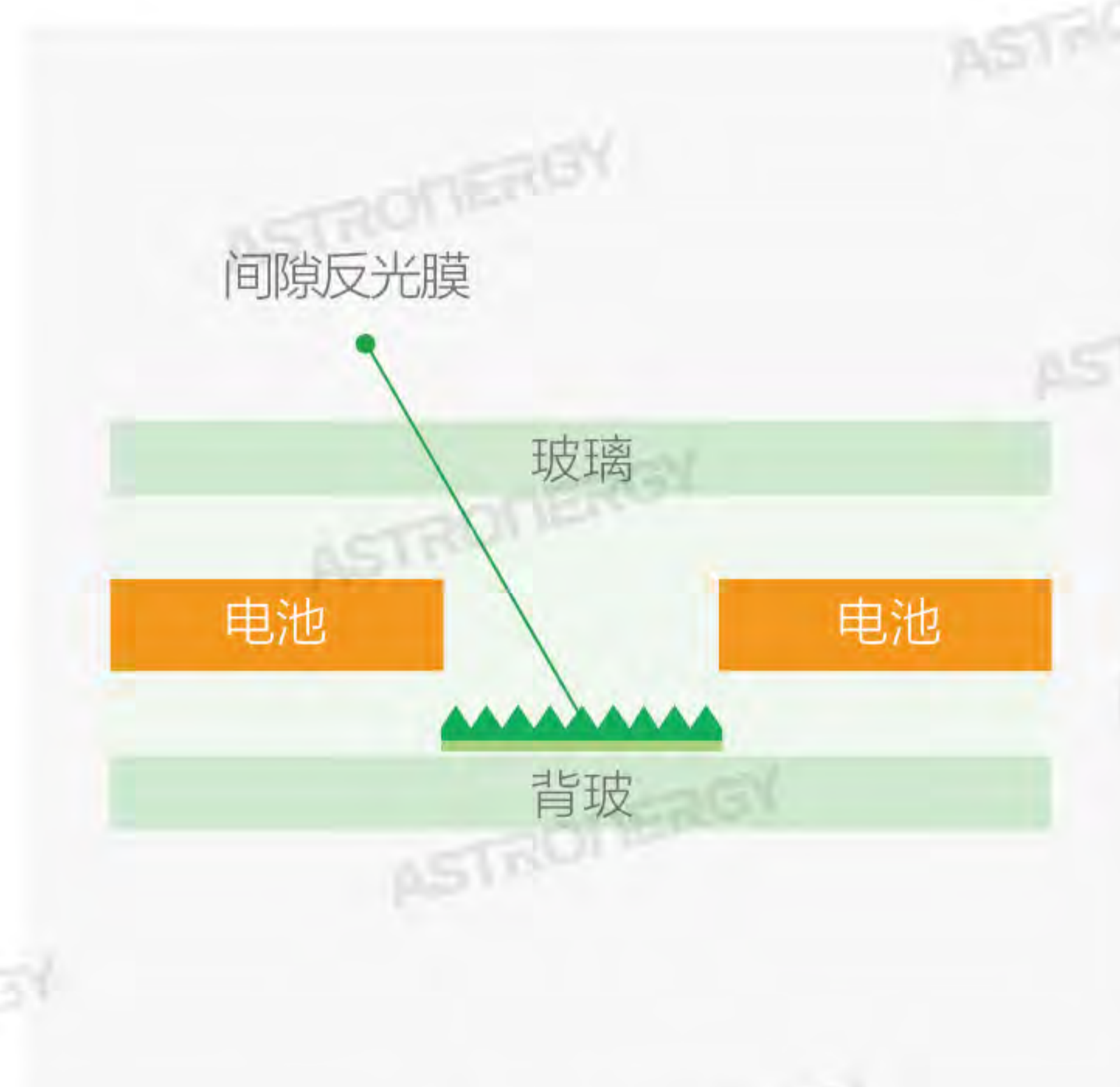
间隙反光膜的作用位置
